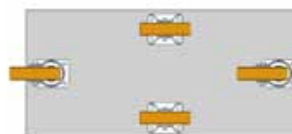
Dwa zestawy skrętne i dwa zestawy stałe, zestawy stałe mają nieco większą wysokość konstrukcyjną
