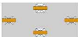
Cztery zestawy kołowe stałe, przy czym środkowe mają nieco większą wysokość konstrukcyjną.
